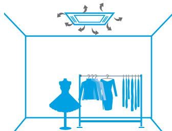
Distribution de l'air avec un filtre encrassé
